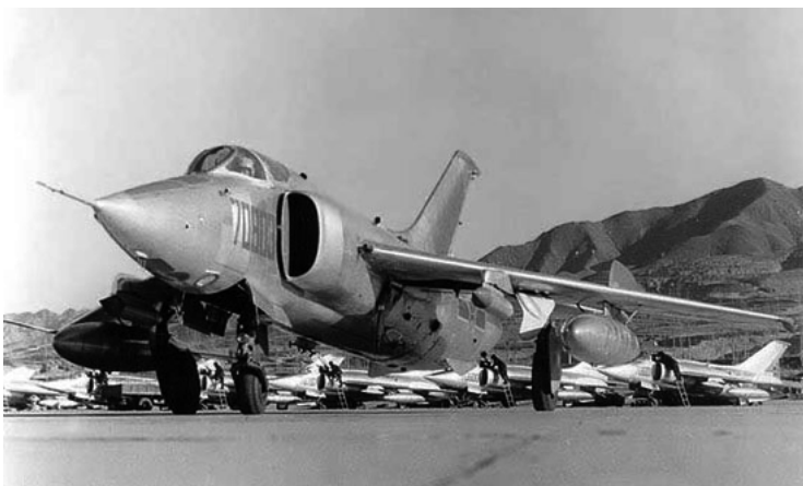
强5原型机（机炮已被移到翼根处）
